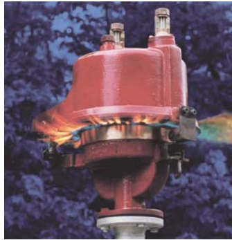
Figura 3a: Prueba de resistencia a la combustión prolongada con la válvula de diafragma con protección dinámica contra la propagación de llamas PROTEGO® UB/SF
